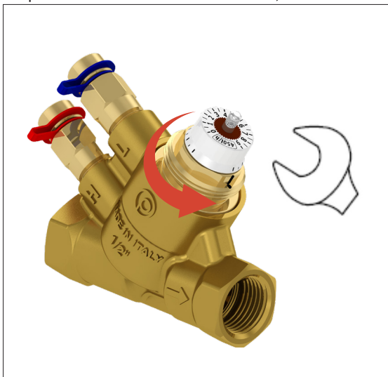
Step 2: usando una chiave da 21 mm, svitare il vitone
